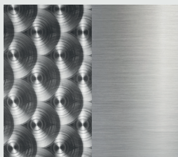
Finitura esterna fiorettrata o satinata External marbled or satin polished Finition extérieure bouchonnée ou brossée
